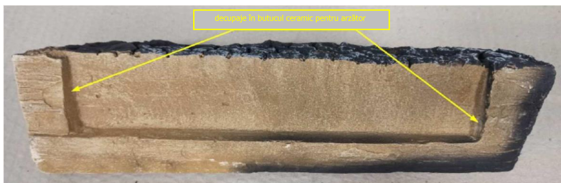
Imaginea 26. Tăieturile de la punctele 2 și 3 facilitează așezarea în colțurile arzătorului.
